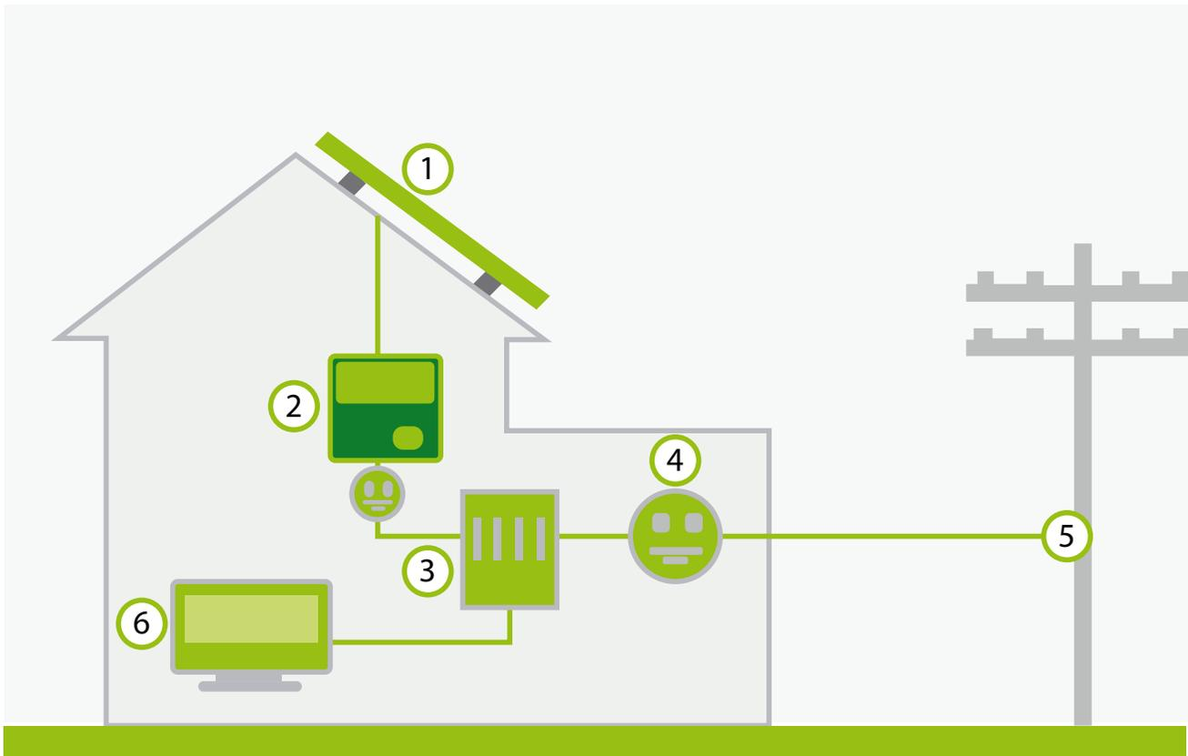
Los Paneles Solares (1), entregan energía que es registrada en un medidor (2).
